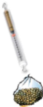
Si aquella bolsita de granos de arroz que se colocó en la balanza de platos, fuera ahora suspendida de un dinamómetro, el resorte interior se estirará. La lectura en la escala, indicará la acción de la Tierra sobre este cuerpo. Es decir, cuánta fuerza ejerce la Tierra sobre la bolsa de arroz. En otras palabras, se leerá el PESO.
