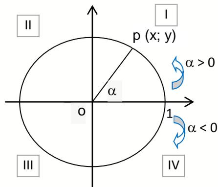
Si un punto  $p$  de coordenadas  $(x, y)$  se desplaza girando sobre la circunferencia, la semirrecta que contiene al segmento  $\overline{op}$  determina un ángulo  $\alpha$  con la dirección positiva del eje  $x$ . Si este punto  $p$  gira en sentido contrario al de las agujas del reloj (sentido antihorario), el ángulo  $\alpha$  es positivo; y si  $p$  gira en el mismo sentido (horario),  $\alpha$  es negativo.
