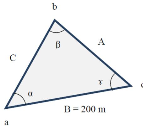
Vemos que la distancia entre a y b es el lado C. Debemos conocer entonces el ángulo  $\beta$  para aplicar el teorema. Con los datos podemos utilizar la propiedad de la suma de los ángulos interiores:
